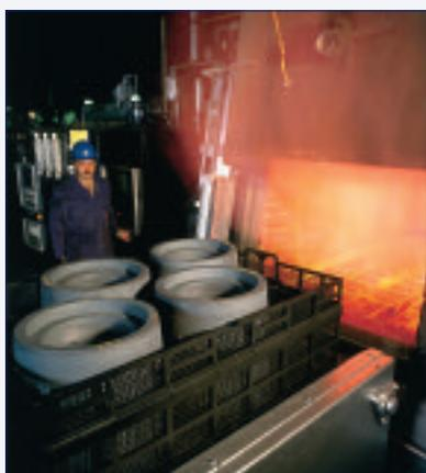
**Distribution als Kernkompetenz** | Dienstleistungen der ersten Bearbeitungsstufe: Plasma-Schmelzschneiden und autogenes Brennschneiden über modernste CNC-gesteuerte Anlagen im Klöckner Stahlhandel Nürnberg (oben). Beladung eines mikroprozessorgesteuerten Schutzgashärteofens zur Behandlung von vorgeschmiedeten Halteringen bei der Tochtergesellschaft Mamesta B.V. in den Niederlanden.
